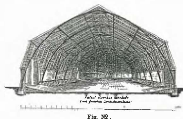
Rungsted Ladegård blev bygget ud fra nye principper med jernbuekonstruktioner, der sikrede et rum uden søjler og var økonomiske i opførelsen. Efter: K. Borring: Jærnbuesystemets anvendelse til landbrugsbygninger.
